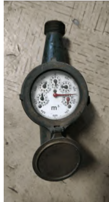
Eine alte Wasseruhr (Wassermesser)
