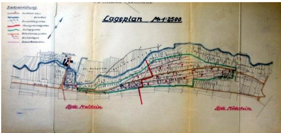
Der Lageplan für die Entwässerungsanlage Zehntackerwiesen
